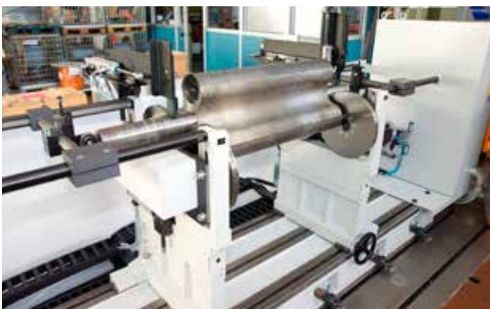
Equilibratrice orizzontale a supporti rigidi con trascinamento mediante rulli motorizzati.
