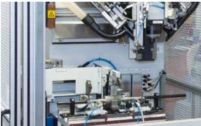
Equilibratrice automatica per piccoli motori elettrici, correzione su due piani per fresatura radiale sugli anelli esterni.
