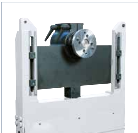
Equipaggi flangiati per equilibrare alberi di trasmissione. Flanged carriage for balancing drive shafts.
