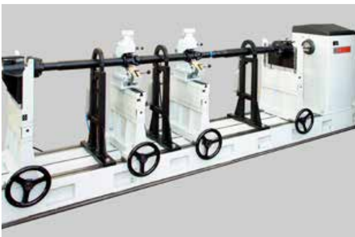
Equilibratrice per alberi di trasmissione con quattro supporti e programma speciale per la lettura dello squilibrio simultaneamente su quattro piani di equilibratura.
