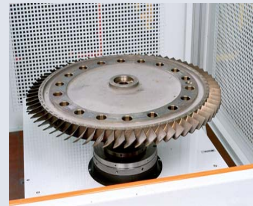
Macchina equilibratrice per giranti di compressore (turbina a gas).
