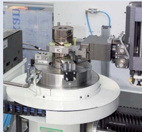
Macchina equilibratrice automatica per particolari di macchine tessili con caricatore automatico e unità di foratura
