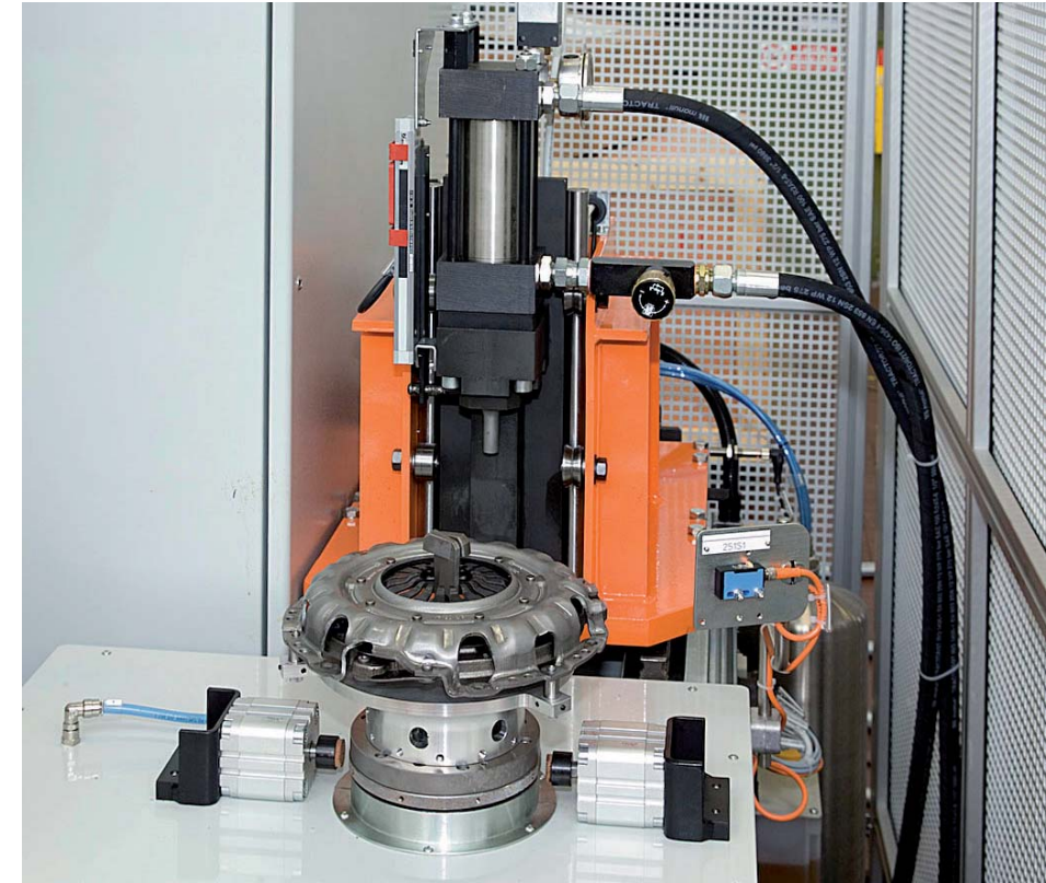
Equilibratrice automatica per frizioni completa di pressa di rivettatura. Automatic balancing machine for clutches equipped with riveting press unit.
