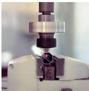
Fließbohren / Flow drilling
